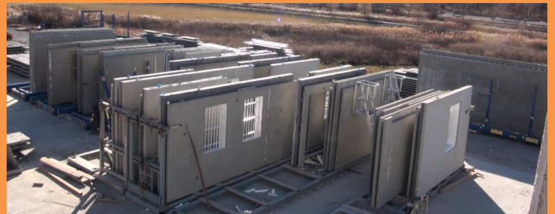
Les Prémurs A2C sont fabriqués en usine dans un carrousel.
